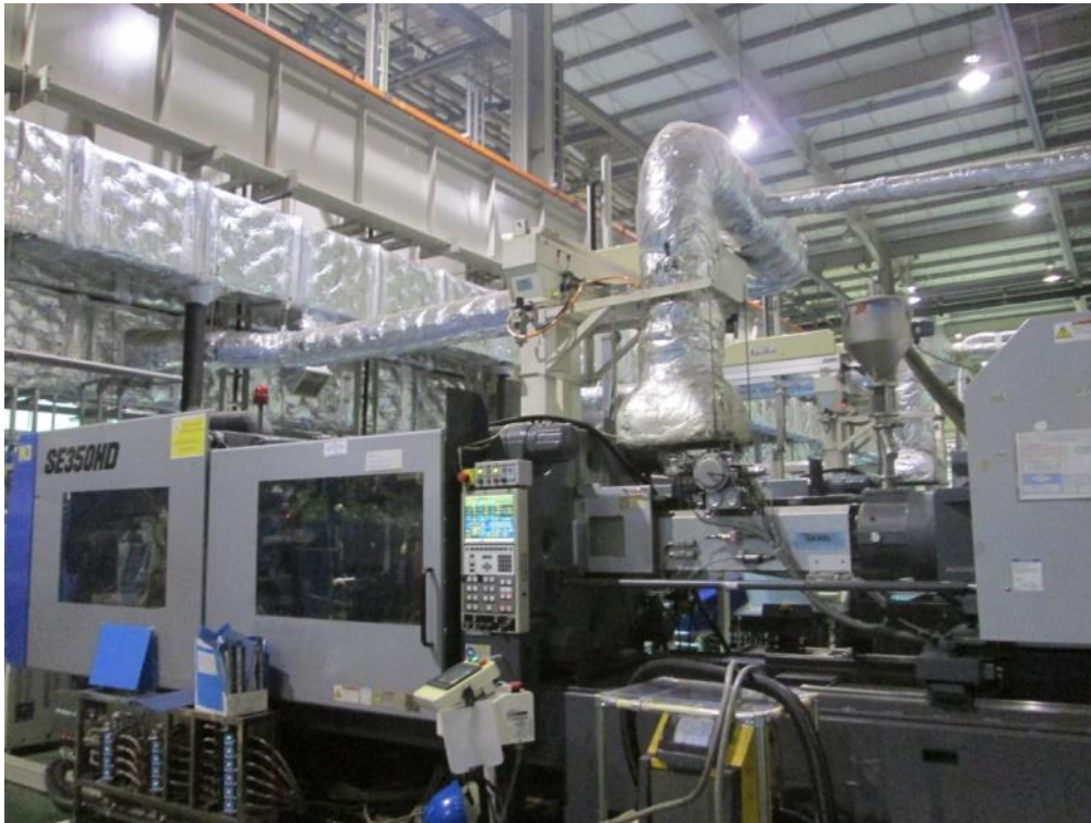
Hình 4.2. Ống hút khí của máy đúc nhựa đặc biệt
